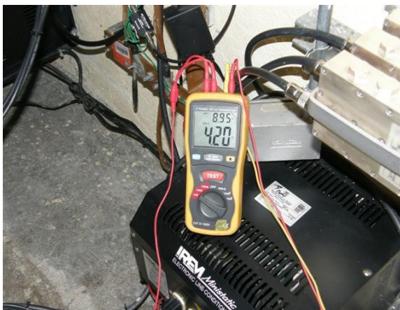
Medida de tierra en salón de equipos
