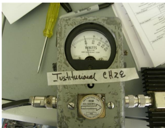
Medida de potencia RMS canal institucional
