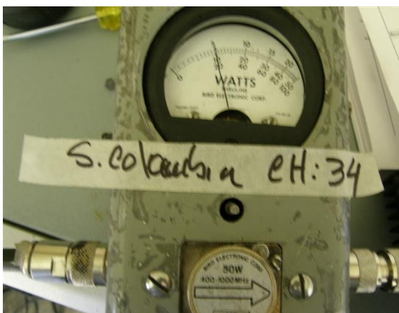
Medida de potencia RMS señal Colombia
