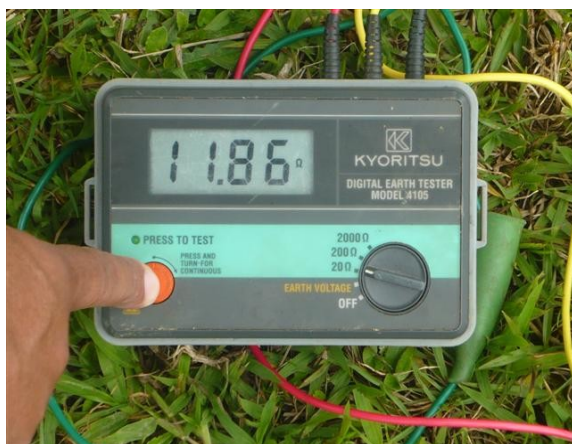
Medida del Sistema de Tierra de la Torre
