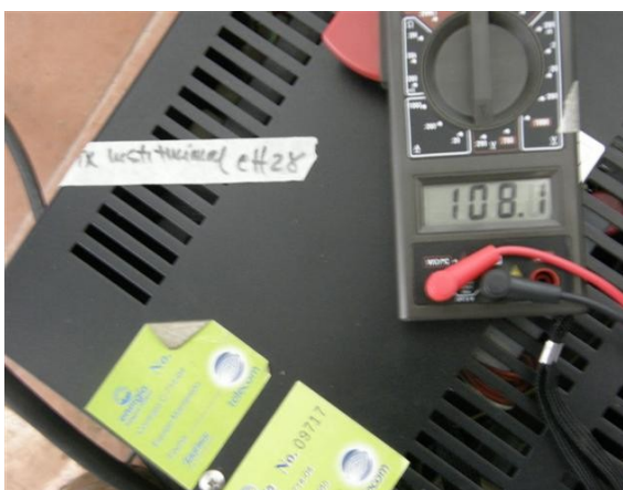
Tensión de salida de los reguladores
