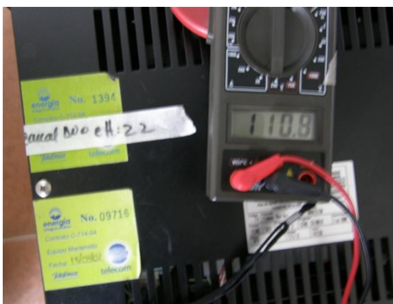
Tensión de salida de los reguladores
