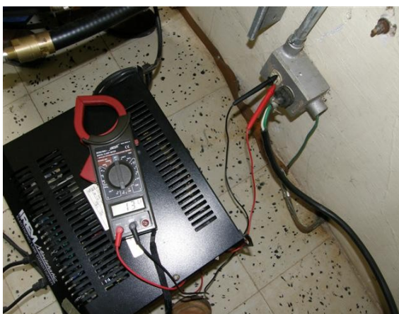
medidas de voltaje en el regulador
