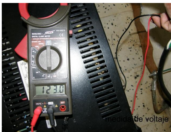
medidas de voltaje en el regulador
