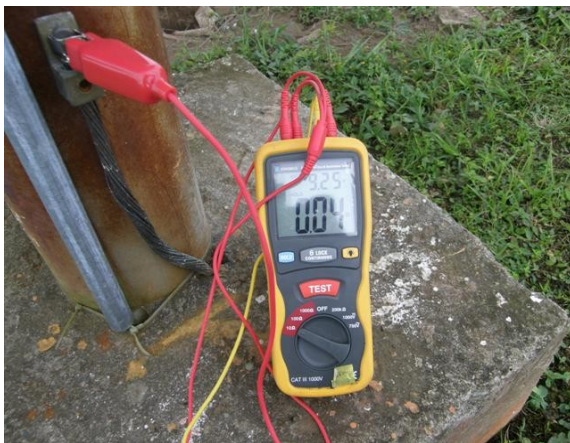
Medida de tierra en parabólica
