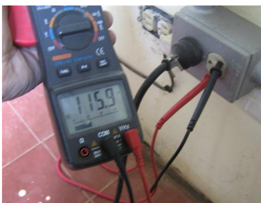
Medición de voltaje toma corriente
