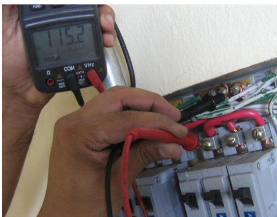
Medición voltaje de fase R
