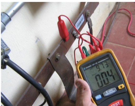
Medición tierra salón de equipos
