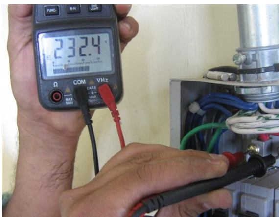
Medición voltaje de linea
