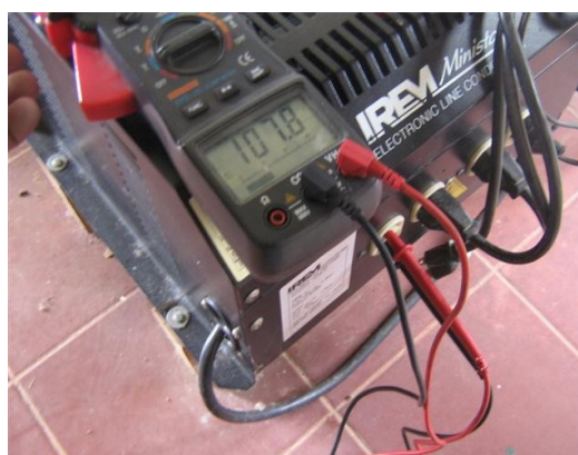
Medición de voltaje salida regulador IREM
