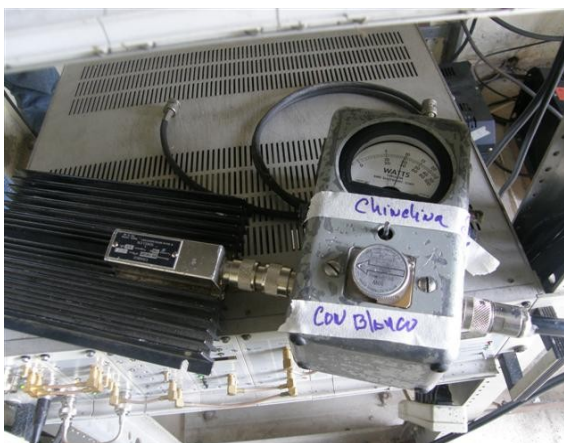
medición de potencias con señal de blanco
