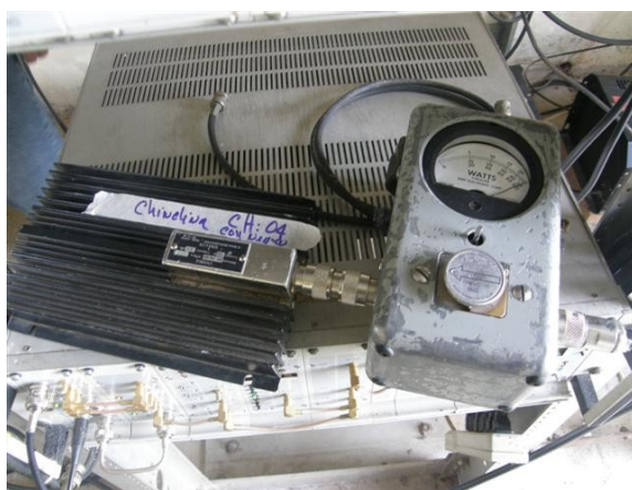
medición de potencias con señal de negro canal 4
