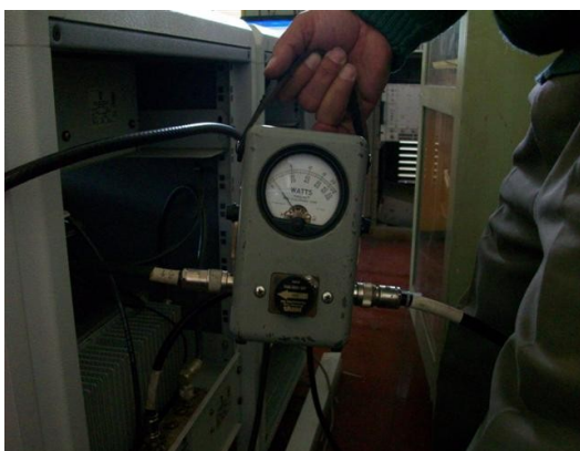
Medida de potencia con señal de negro SI
