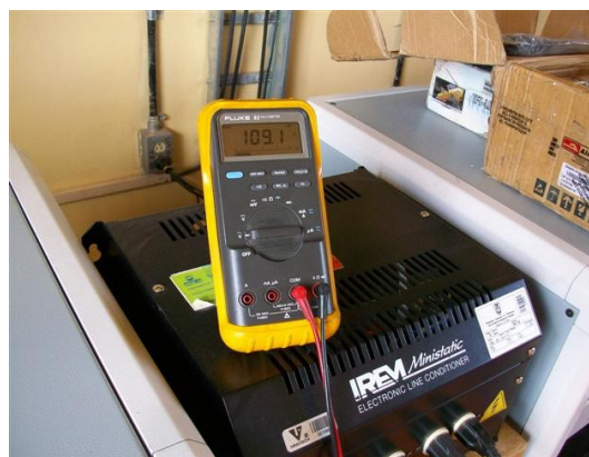
Medida voltaje regulador C 1
