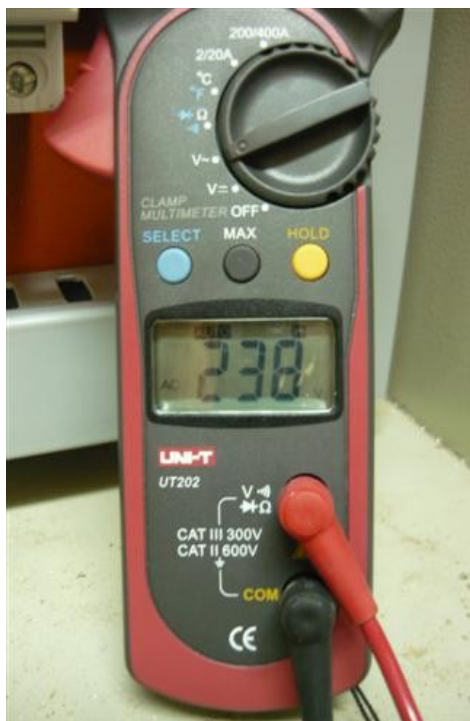
Voltaje de linea R_S
