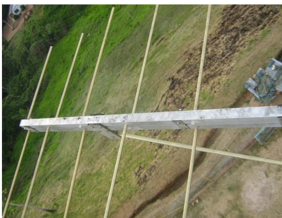
Antena Yagi V-2 20,3 Mts
