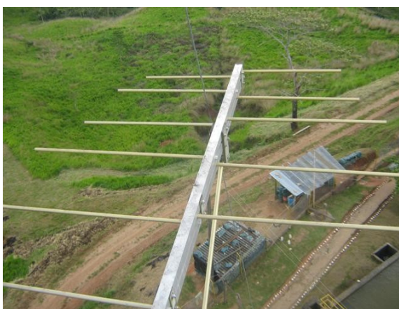
Antena Yagi V4- 20,3 Mts
