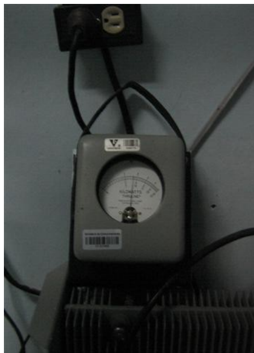
Medida de potencia Wrms – Transmisor Harris - Cadena Uno
