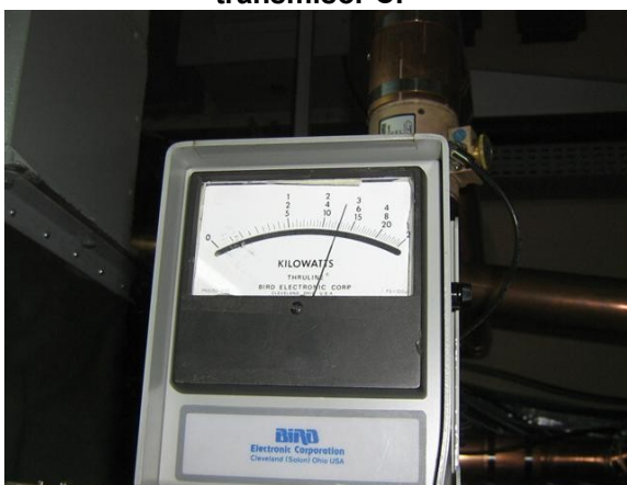
Medición de potencia directa con negro CI
