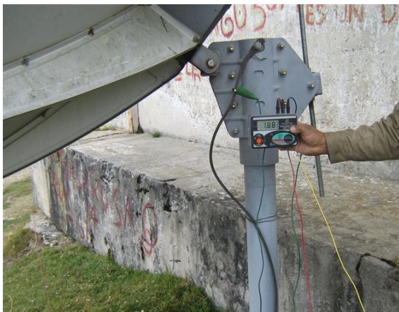
medición de sistema de puesta a tierra antena parabólica R.T.V.C
