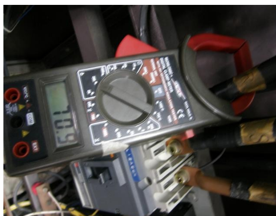
Corriente fase R totalizador principal
