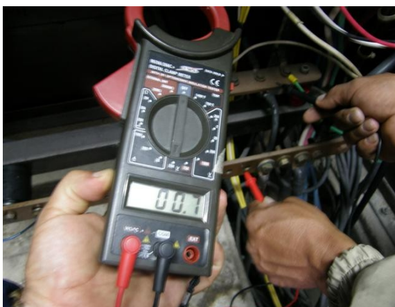
Voltaje neutro – tierra totalizador principal
