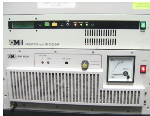
Panel de medidas Tx Radio Nacional dañado
