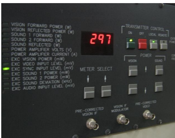
nivel de sync de entrada Tx principal SC
