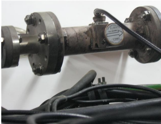
Capsula para mediciones de potencia
