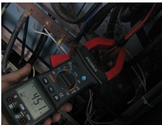
Medición corriente fase R
