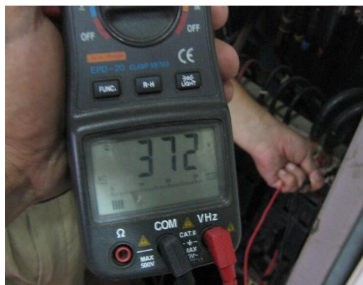
Medición voltaje S-T
