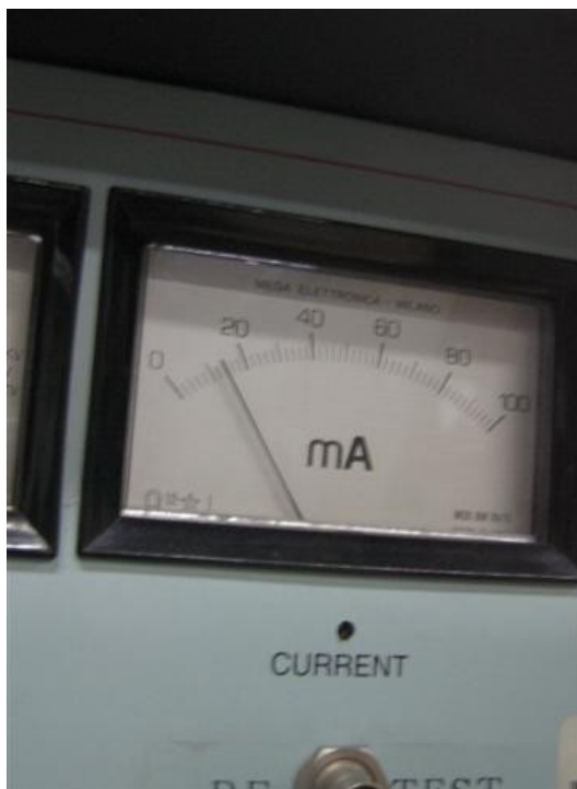
Medición de corriente de grilla radio nacional
