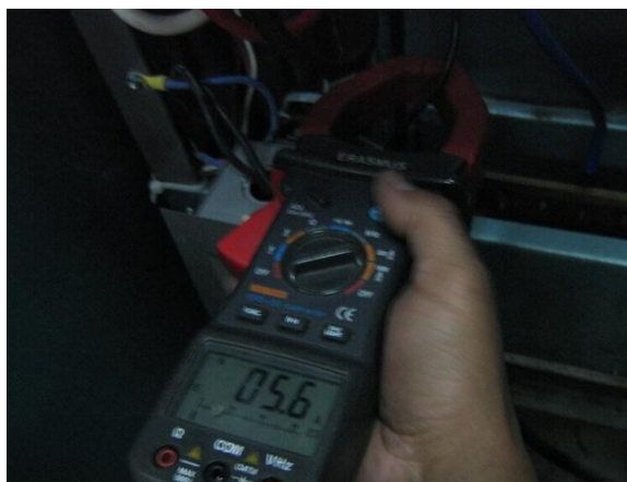
Medición de consumo radio red hospitalaria
