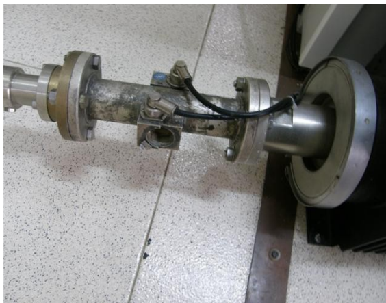
Truline sin diodo no se pudo medir potencias con señal de negro
