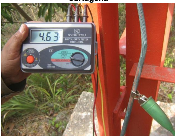
Medición tierra Pararrayos Torre
