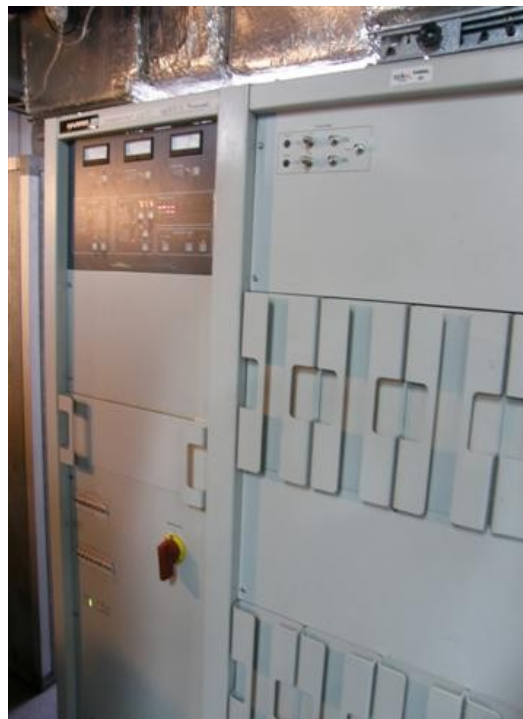
Transmisor harris canal 21 falla en audio
