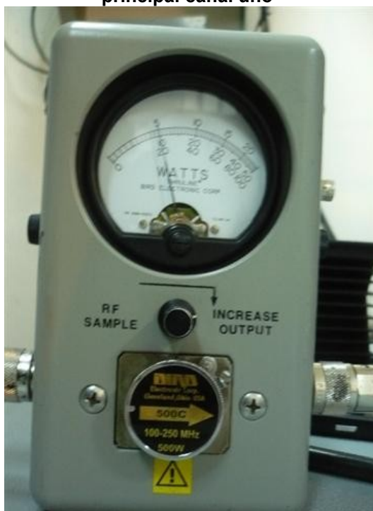
Medida de potencia con señal de negro tx thompson señal Colombia
