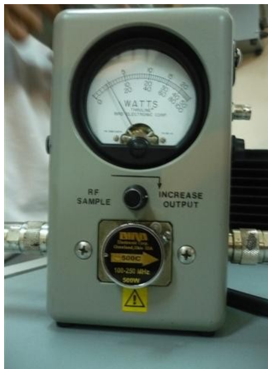
Medida de potencia con señal de negro tx principal señal Colombia screen service.
