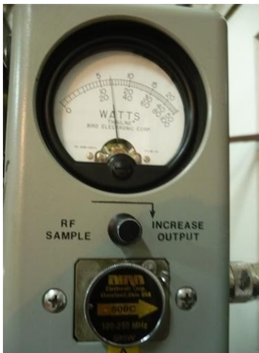
Medida de potencia con señal de negro tx principal canal uno
