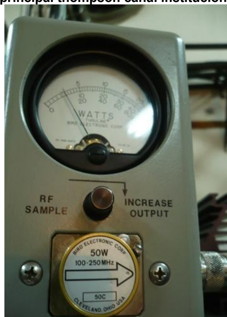
Medición de potencia con señal de negro. SI TX principal
