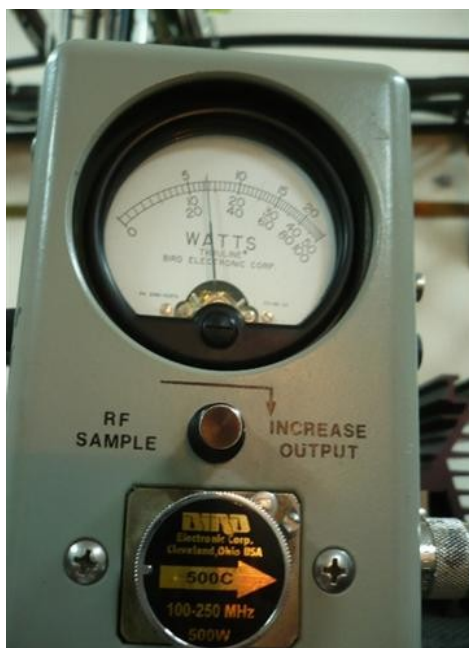
Medición de potencia con señal de negro tx thompson reserva
