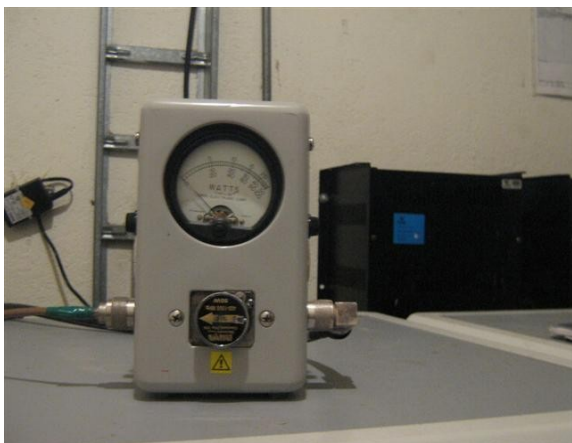
Medición de potencia reflejada Canal Institucional
