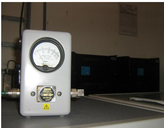
Medición de potencia Directa Canal Institucional
