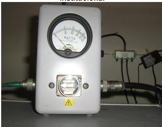
Medición de potencia reflejada Señal Colombia
