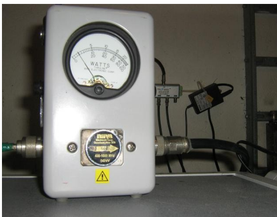
Medición potencia Directa Señal Colombia
