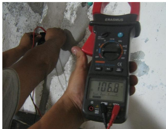
Medición voltaje Fase - Neutro
