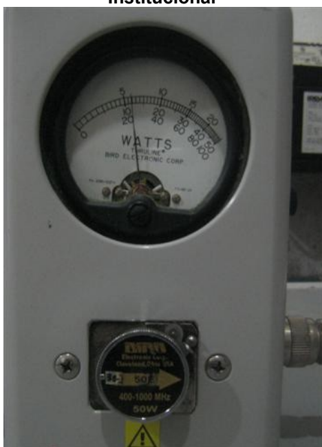
Medición de potencia directa Señal Colombia
