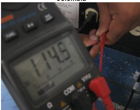
Medición de voltaje IREM Señal Colombia
