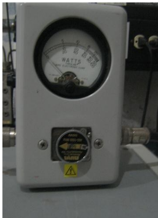
Medición de potencia Reflejada Señal Colombia
