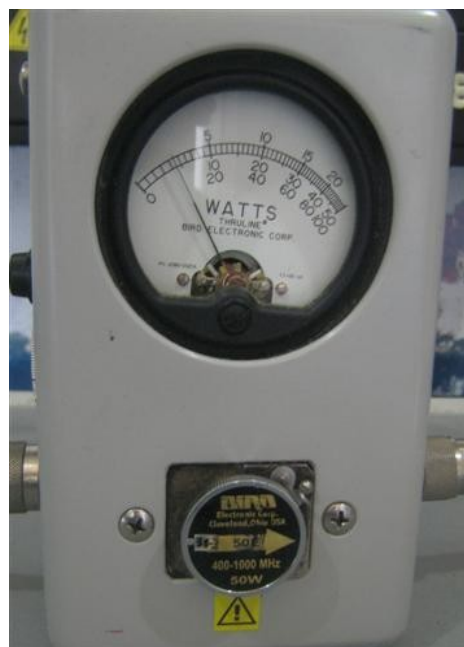
Medición de potencia directa Canal Uno
