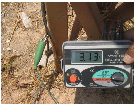
Medición sistema tierra Torre
