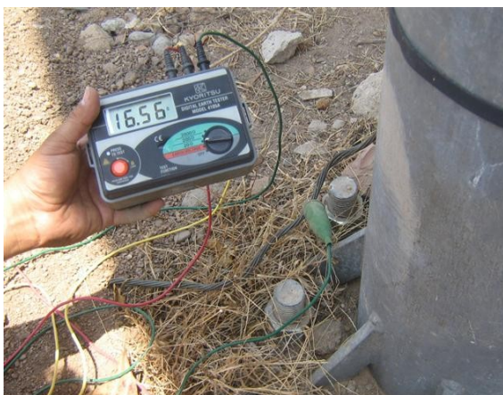
Medición tierra Antena Parabólica
