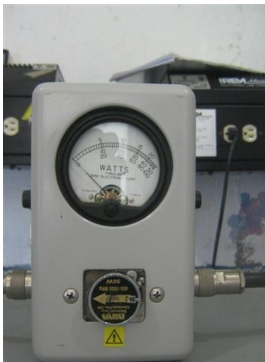
Medición de potencia reflejada Canal Uno
